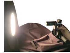
Figura 2. Montaje de espectrorradiómetro ASD FieldSpec® 3 midiendo la esfera integradora Labsphere CSTM-USS-4000.
