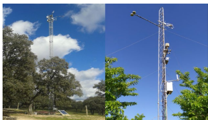
Figura 1. Torres de covarianza de torbellinos en la Sierra de Cardaña y Montoro (izquierda) y en almendros, en Tarazona de la Mancha (derecha).
