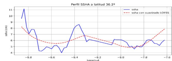
Figura 3. Efecto del filtro Loess sobre una franja longitudinal para 550 puntos en el evento de calma (30/12/2023).
