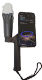
Figura 2. Sistema móvil de captura de datos integrado por un iPhone 15 Pro Max y un receptor Emlid Reach RX.
